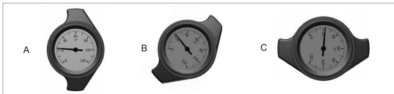
Рис. 5: Положения рукоятки термометра
