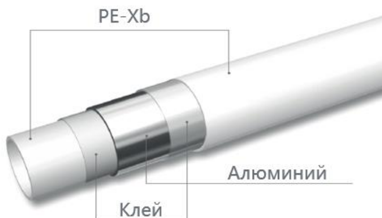
Рис. 1 Конструкция трубы RIIFO Omni.
