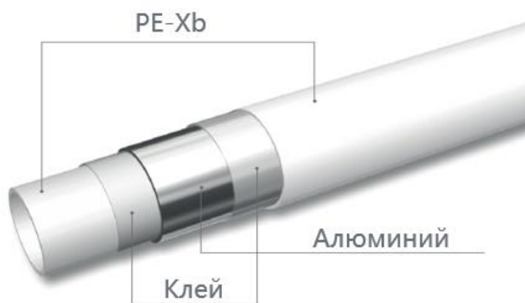
Рис.1 Конструкция трубы RIIFO Omni.
